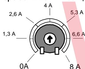
Насос защищен электроникой от повреждений, вызванных токовой перегрузкой. Для настройки защиты под конкретный насос необходимо согласовать величину тока срабатывания защиты с рабочим током насоса (смотри табличку на двигателе). Регулятор тока срабатывания находится внутри блока управления на монтажной плате. Если рабочий ток двигателя насоса не известен, то можно настроить защиту следующим образом:
