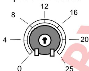
Максимальное время работы насоса можно установить с помощью потенциометра расположенного на монтажной плате. По истечении заданного времени насос автоматически отключится. Установка регулятора в крайнее левое положение позволяет отключить таймер. При этом насос не будет автоматически отключаться, лишь повторное нажатие EL-кнопки отключит его.
